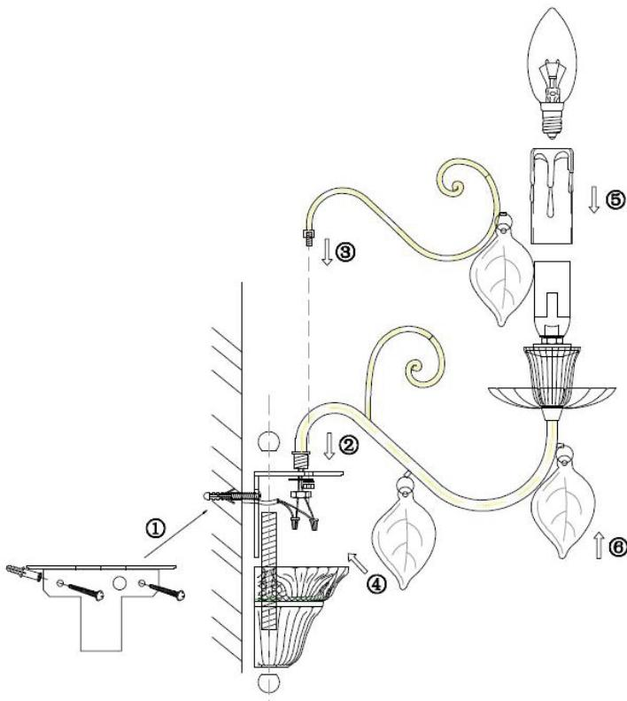
1. Просверлить ударной дрелью в стене отверстия для пластиковых дюбелей. Привернуть с помощью саморезов крепежную планку.
