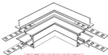
Внешний угловой соединитель. №2 на схеме №3
